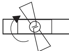
第四步 | 将生料带缠在2个弯角接头小端螺纹处缠绕数圈,大端为垫片密封无需缠绕生料带。再将缠生料带部分旋入预埋水管内旋紧;
