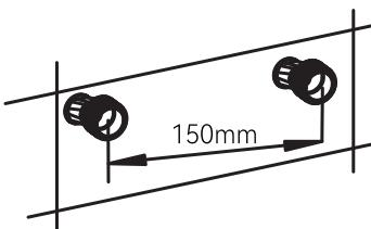
第六步 | 先将垫片放入龙头接头的出水孔中。装饰盖装入弯角接头与墙接触,再将龙头的螺母与弯角接头旋紧;
