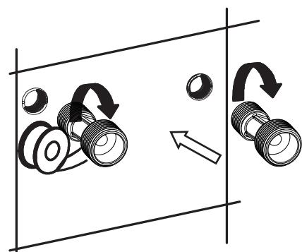
第五步 | 微调两个弯脚接头的中心距离为150mm,且在同一水平高度上;
